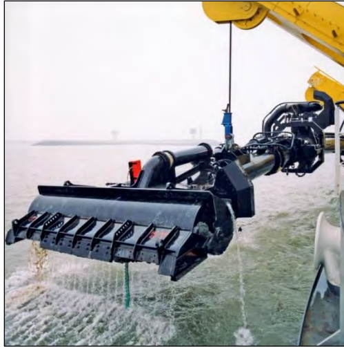
Figura VII-11. Cabezal de succión de una TSHD
